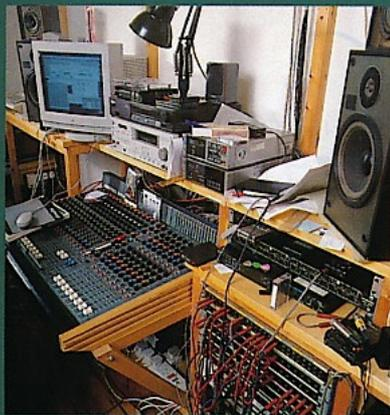
デヴィッド・カニンガム・スタジオの中核となるコンソールSOUNDTRACS 16・8・16とAPPLE PowerMacintosh (型番不明) のディスプレイ。インテリナーにもあるようにDIGIDESIGN Pro Tools IIIを使用して、過去の音楽素材をリミックスしているということ。コンピューターはほかにATARIや左端に見えるAPPLE IIeも現在使用しているようだ。コンソールの上にはSONY PSU/Beta VCR、SONY 701-ES、FOSTEXのDATレコーダーD-25が並ぶ。その下のラックにはDRAWMERのノイズゲートDS-201、YAMAHA EM110、ALESIS Micro verb、SONYのコンパクトDAT TOD-D3などが雑然と置かれている。また写真にはないが、マスター・キーボードはCASIO HT700を使用している。テープレコーダーの数に比べて、ほとんどシンセサイザーと呼べるものがないのは、いかにもデヴィッド・カニンガムらしい
